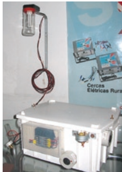
Protótipo do lâmpião solar desenvolvido pelo Ideas para os pescadores de camarão de São José do Norte. É composto pela bateria, controlador de carga, tomadas para serem conectadas ao painel solar e outra que utiliza a eletricidade armazenada na bateria. Possui sistemas de fusíveis que previnem acidentes
